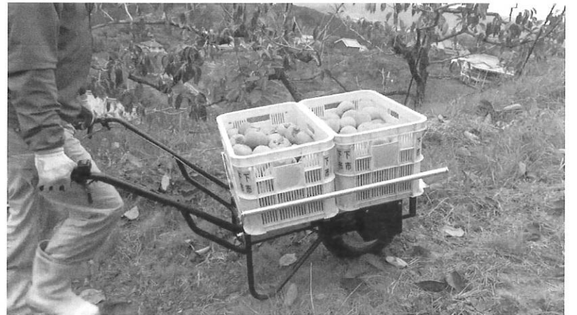
写真3 もっと小回りのきく運搬車をという栃原地区の皆さんの要望に応え、電動の輪車も開発。
