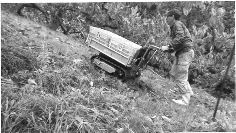
写真1 らくらく電動運搬車 栃原地区の皆さんの意見を受けてクローラー型に変更し実用性が増す。
