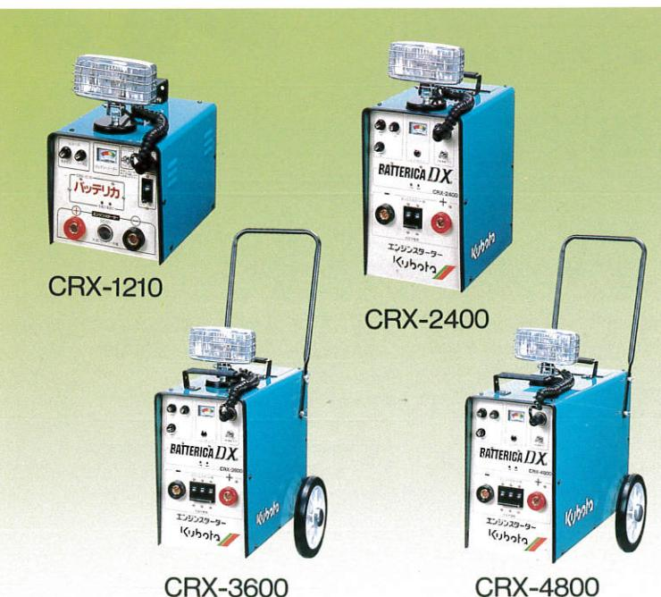
ミニバックホー、ホイロードなどの小型建機やトラクタ、コンバインなど農業機械から大型建機、大型トラックまで多彩な機器のエンジン始動や充電器、さらに補助照明機器としてフルにその性能を発揮するバッテリカDX。過充電防止機能や内部充電用電池の劣化を抑えるICコントローラー。また外部バッテリー充電回路に逆接防止用ブレーカーなど数々の安全装置を内蔵。多彩な用途、安定した力で、さまざまなシーンでの活用に応えます。
