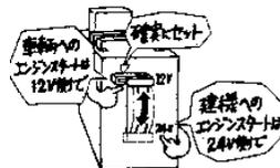
④番(ブレーカー)をエンジンスタート「ON」(上)側にしてから次にブースターケーブルのプラス(赤色)ワニグチクリップを相手バッテリーのプラス(+)側に、マイナス(黒色)ワニグチクリップをマイナス(-)側に接続してください。(この時、ブレーカーがトリップ(OFF)になる場合は逆接続ですのでプラス、マイナスを再確認してください。)
